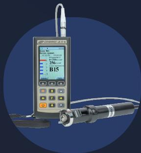
Инструмент для определения содержания влаги и прочности основания
